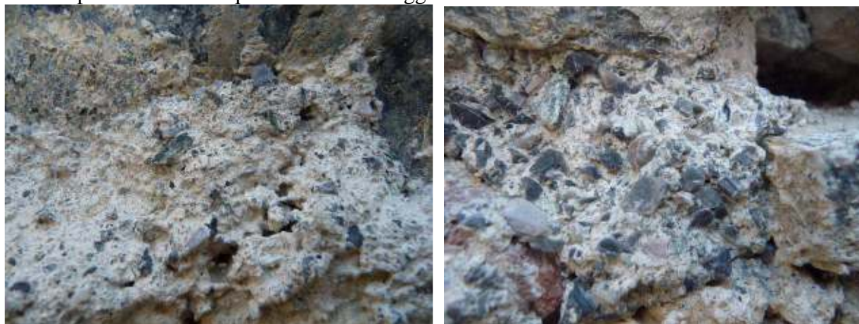
Fig.12. Malta utilizzata nel restauro. Fig. 13. Una delle malte storiche (ve ne sono molti tipi che corrispondono a diversi interventi che si sono succeduti nel tempo). La malta utilizzata nel restauro è a base di calce; si differenzia da quelle storiche per l'impiego di un aggregato non di origine marina.
